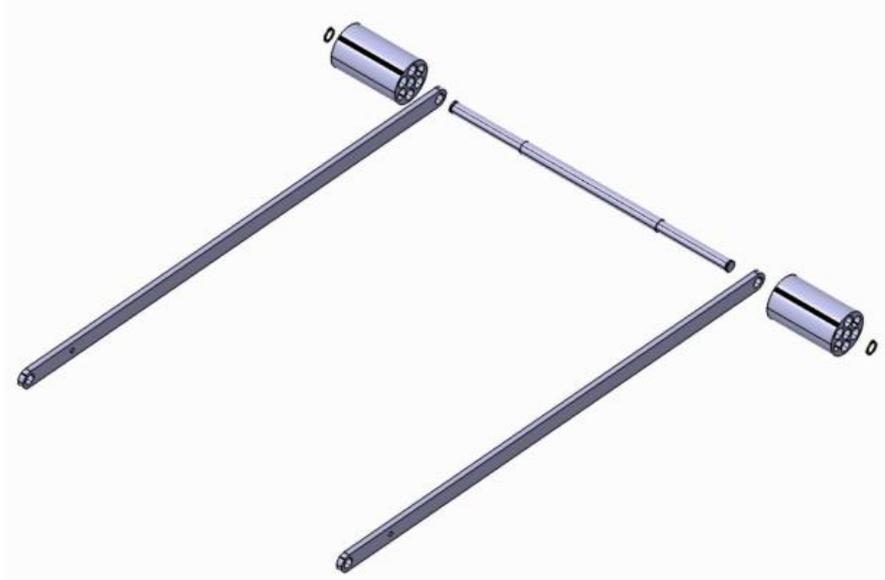
L'assemblage suivant est l'ASSEMBLAGE POIGNEE (cf. pièce n°62), où on trouve deux MONTANT POIGNEE (cf. pièce n°42), dans lesquels on enfile l'AXE POIGNEE (cf. pièce n°41) de part et d'autre. Ensuite nous trouvons les deux POIGNEE (cf. pièce n°43), qui seront à leur tour enfilées dans l'AXE POIGNEE, et qui y seront fixés grâce à deux CIRCLIP (cf. pièce n°32).
